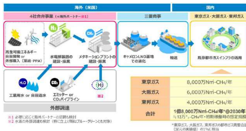
《図表 2-10》 日本への合成メタン導入スキーム (検討例)
